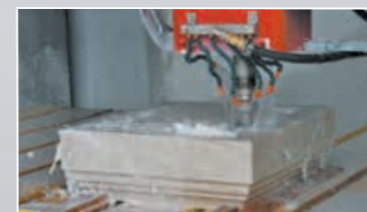
11. Realizzazione lavelli con mole da scasso Execution of wash-basins with diamond tools Réalisation d'éviers avec meule de décaissé Realizaciones de lavabos macizos con muela de rebaje
