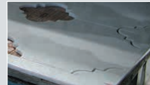
9. Tagli con fresa a candela Core bit cuts Coupe avec fraise chandelle Corte con herramienta tipo fresolin
