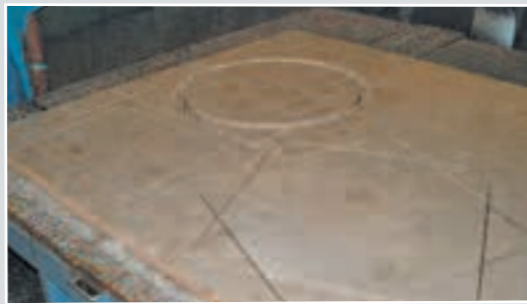
1. Tagli ortogonali con disco Orthogonal cuts with disc Coupes orthogonales au disque Corte octogonal con disco
