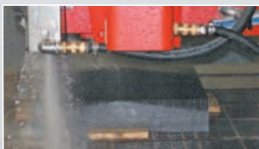
3. Pettinatura lineare con disco Straight-line shaping with disc Profil droit au disque Corte del Disco a pasada en forma linea
